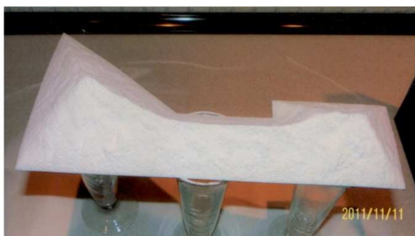
Fot. 1: Pryzma z mąki krupczatki usypana na wielokącie z dwoma kątami wklęsłymi
