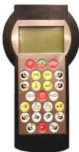
Rys. 2 Radiowy Sterownik Operatorski RSO-25, służący do sterowania kombajnem i przenośnikiem
