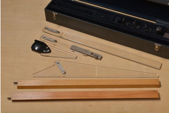
Rys. 1 Perspektograf firmy PREMA, made in Czechoslovakia, lata 50. XX w.
