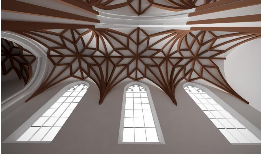
Rys. 2 Wizualizacja sklepienia gwiazdzystego, model cyfrowy analogiczny do oryginalnych przesł w prezbiterium kościoła św. Jana w Gdańsku
